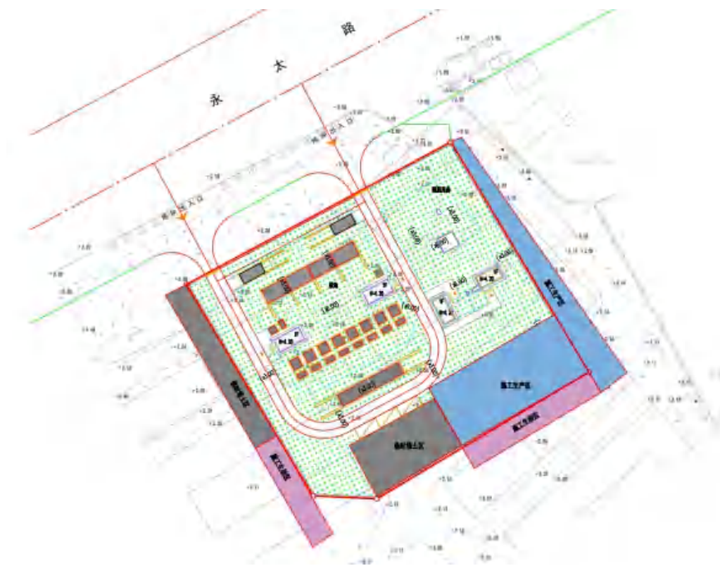
图 2-7 施工临建区及临时堆土区示意图
